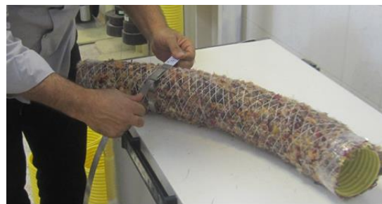
شکل ۳. اندازه‌گیری ضخامت پوشش‌های مصنوعی توسط سیرکومتر
