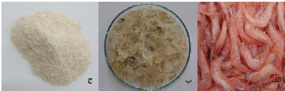
شکل ۱- مراحل تولید کیتوزان از پوسته میگو. الف) میگو با پوست (ب) پوسته‌های شسته و خشک شده میگو (ج) کیتوزان استحصال شده از پوسته میگو.
